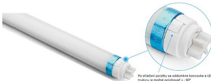
Po stlačení poistky sa oddomkne koncovka a LED trubicu je možné polohovať + - 90°
